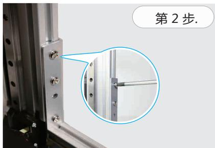
使用包装内的 3 个大号螺丝将 Z 轴安装至基座上。
