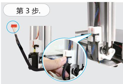
将 Y 轴电机电缆推入白色电缆固定器内。
